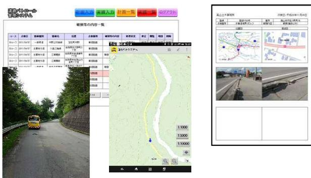
「道路パトロール管理システム」はパトロールで発見された異常箇所について位置情報とともに処理状況の適正管理が行えます。異常箇所データを蓄積させることで、破損が発生しやすい箇所の特定が容易となるなど、道路の維持管理計画の立案に有効です。また、専用調書を自動的に生成することで、パトロール業務の効率化が図れます。
