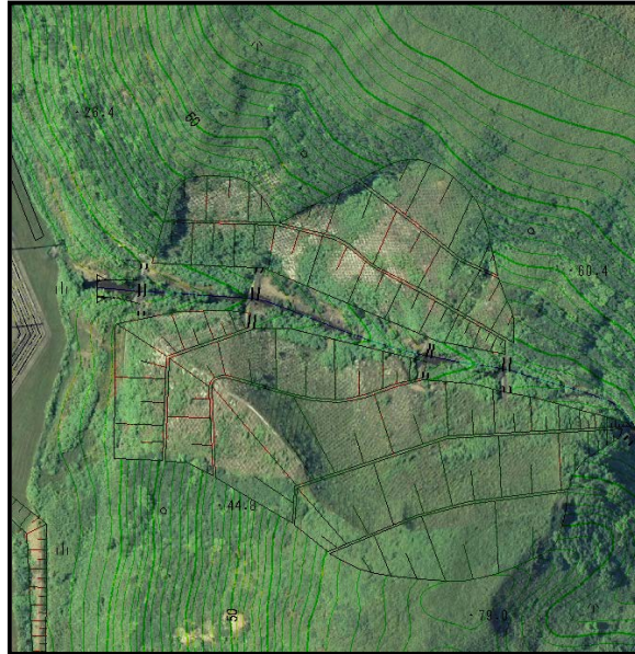
図 20-8 オルソ画像と共有空間データの重ね図による点検
