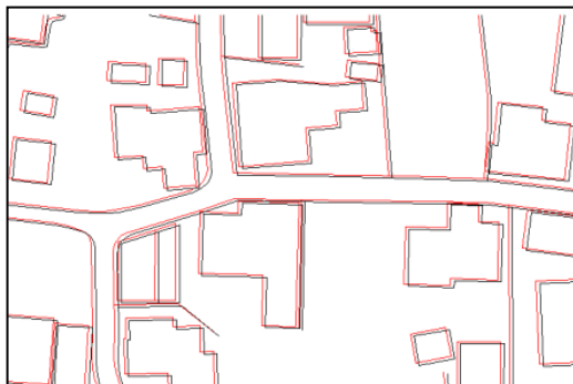
図 19-3 空中三角測量による相対的な位置ズレ
